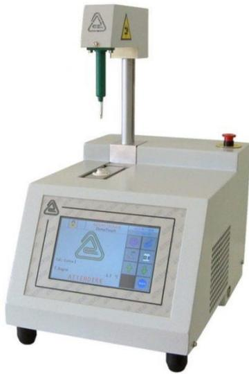
OsmoTouch 1 est un osmomètre automatique à échantillon unique pour la détermination rapide de l'osmolalité dans les fluides biologiques, les échantillons pharmaceutiques et autres solutions au moyen de la variation de point cryoscopique.
